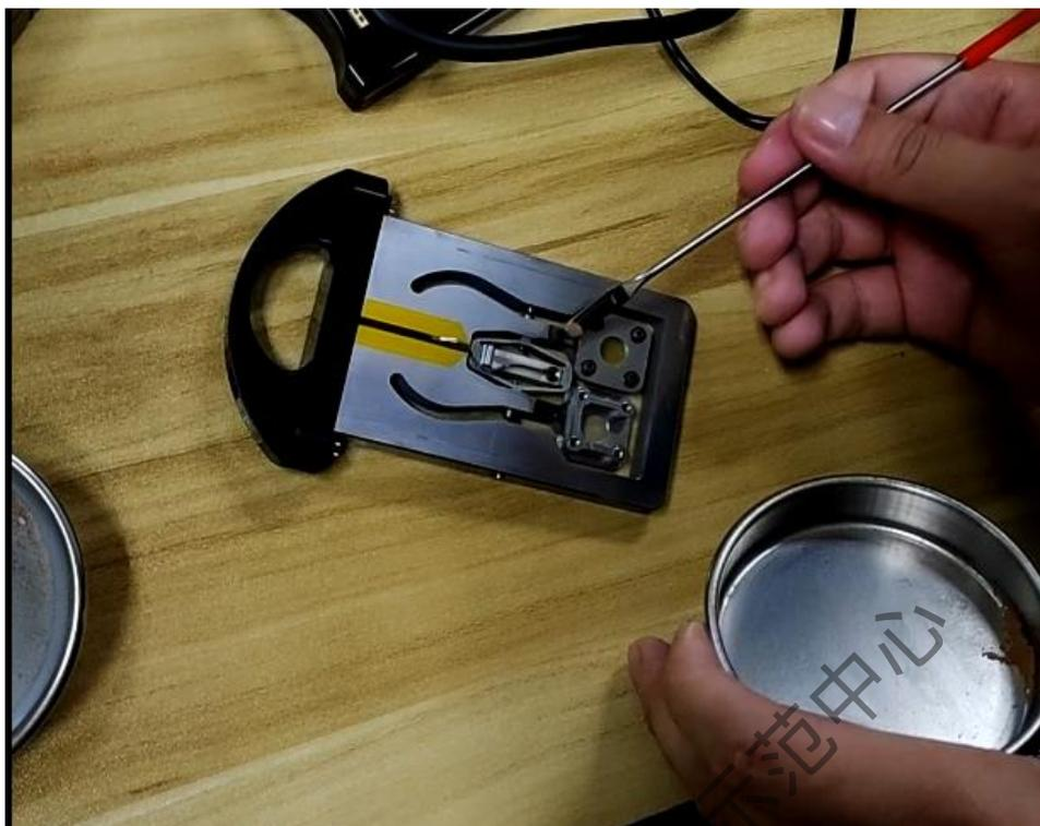
3. 将振荡器如图装好，注意正反。之后用上下键在主菜单界面选择“SHAKE”，按下“√”键，此时振荡器会开始震荡，将样品送入样品池内，此时可以用左右键选择振荡力度。当样品基本完全进入样品池后，按下“×”键停止震荡。基本上样品能覆盖样品池约 3/4 的空间即可，不用太多。
